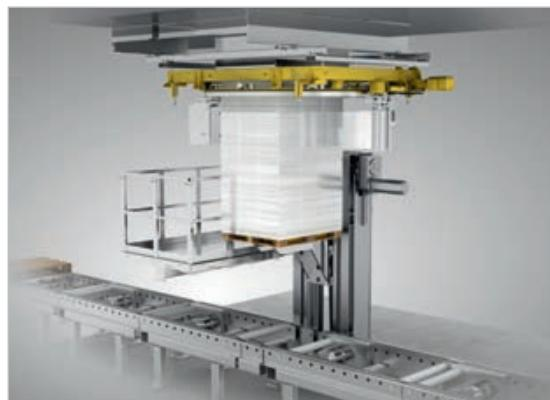
La palette filmée est évacuée par convoyeur. L'évacuation peut être aussi effectuée manuellement (en option). Le laps de temps entre 2 palettes ne dure que quelques secondes.
